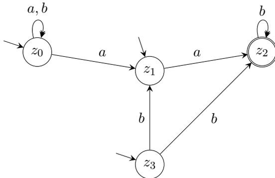
Berechnen Sie einen DFA  $B$  aus dem NFA  $A$  mit der Potenzmengenkonstruktion. Es ist ausreichend die erreichbaren Zustände von  $B$  anzugeben.
