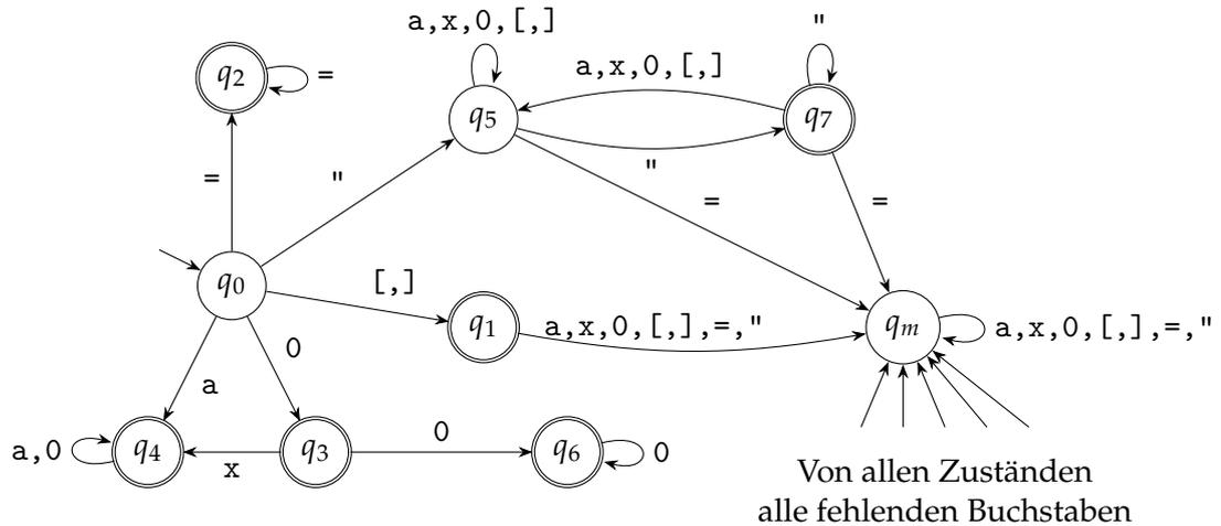
Um das erste Token aus einem String zu identifizieren, wird  $A$  vom Anfang des Strings aus laufen gelassen. Wenn der Lauf nie in einen Endzustand kommt, meldet der Tokenizer einen Fehler. Ansonsten wird die *letzte* Position, in welcher der Automat in einem Endzustand war, als Token-Ende genommen.
